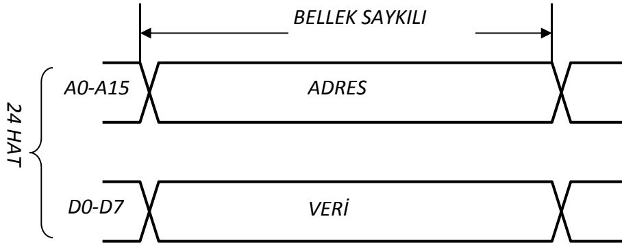
Şekil-2.12 Zaman paylaşım adres ve veri yolunun zamanlama diyagramı.
