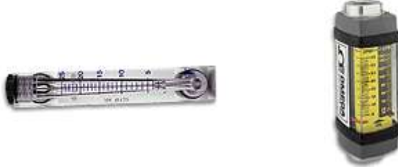
Şekil 7.10 Rotametre şamandırası konik tüp içinde debi ile doğru orantılı olarak yükselir.
