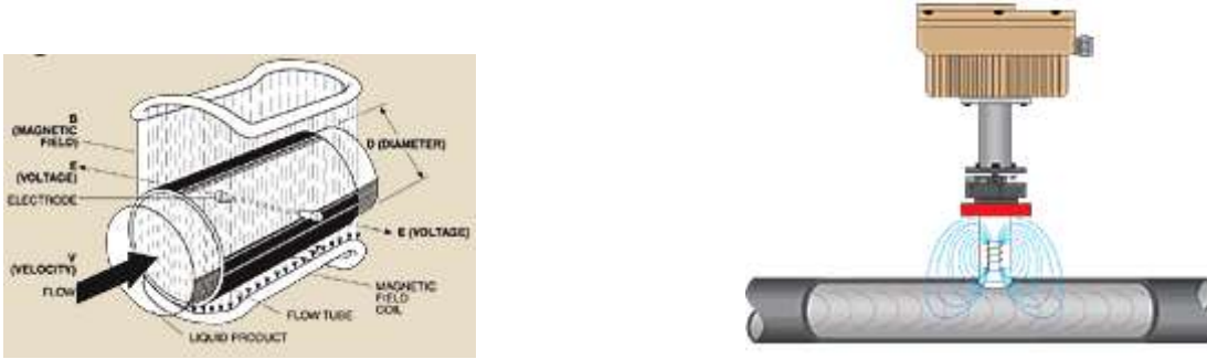
Şekil 7.14 Manyetik sayacın çalışmasını gösteren bu resimde alt ve üstte mıknatıslar ile manyetik alanın (B) yarattığı gerilim (E) belirtilmektedir. Boru çapı (D), akış (V) ile gösterilmiştir.
