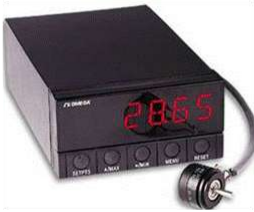
Şekil 4.11 Açısal potansiyometrik yerdeğiştirme transdüseri (RP101, Omega Inc.)
